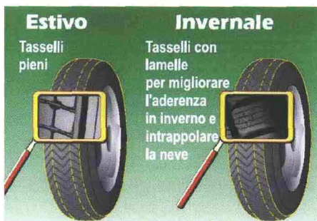
Le differenze del battistrada nel pneumatico invernale e in quello estivo.
